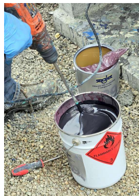
Seajet 039 vsebuje tudi baker katerega moraš vmešati v barvo; to sedaj prvič delamo na tak način
