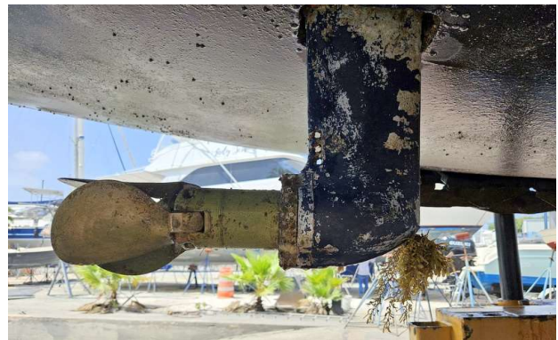
salgarške alge so našle svojo pot v luknjo za hlajenje motorja; propeler je ok (propspeed), antifouling je pa malo popustil
